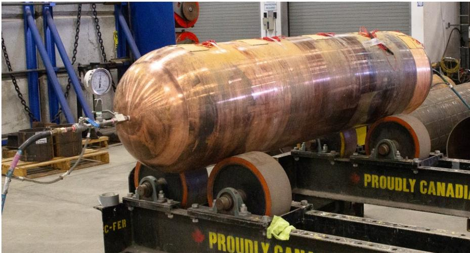
*La SGDN a réalisé un essai de pression sur les Conteneurs de combustible irradié en acier recouvert de cuivre, qui sont conçus pour résister à la corrosion et à des conditions extrêmes.*
